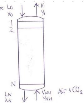
Antar at med inert, mens alle gasser i luftstrommen som ikke er CO<sub>2</sub>:  $\Rightarrow V' = V_{NH} \cdot y_{NH}^{inert} = V_{NH} (1 - y_{NH})$
