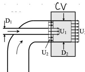
En jet-pumpe injiserer vann med hastighet  $U_1 = 40 \text{ m/s}$  gjennom et rør med diameter  $D_1 = 3 \text{ tommer}$  inn i et rør med diameter  $D_2 = 10 \text{ tommer}$  der vannhastigheten  $U_2 = 3 \text{ m/s}$  (i det annulære mellomrommet). Et stykke ned i røret har de to strømmene blandet seg sammen.
