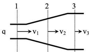
Finn gjennomsnittshastighetene  $v_1$ ,  $v_2$  og  $v_3$  i røret til venstre. Volumstrømmen  $q = 800$  liter/min og snittene 1, 2 og 3 har diameter på 50, 60 og 100 mm.
