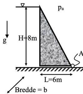
En demning sperrer vann med konstant tetthet  $\rho_{VANN}$ . Demningen har høyde  $H$ , lengde  $L$  og en bredde  $b$  inn i papirplanet. Den er bygd av sement med relativ tetthet  $SG$  ( $= \rho_{SEMENT} / \rho_{VANN}$ ).
