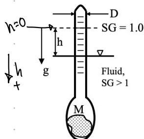
Hydrometeret brukes som en enkel tethetsmåler. Stammen har en konstant diameter D, og massen M er (stort sett) lokalisert i bunnen slik at den flyter stabilt i vertikal-retning som vist. Hvis posisjonen  $h = 0$  er måling i vann ( $SG = 1.0$ ), vis at h ved måling i en eller annen væske med ukjent SG blir:
