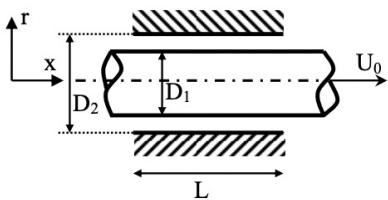
Et massivt rør med diameteter  $D_1 = 122$  mm er plassert inne i en konsentrisk sylinder med indre diameter  $D_2 = 125$  mm og lengde  $L = 200$  mm. Det er olje med *kinematisk viskositet*  $\nu = 30$  cSt og relativ tetthet  $SG = 0.9$  i gapet mellom røret og sylinderen. Finn kraften som skal til for å bevege røret med en hastighet  $U_0 = 1$  m/s idet vi antar at oljens hastighet varierer *lineært* i gapet.
