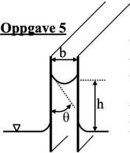
To glassplater er plassert vertikalt ned i vann som vist i figuren til venstre. Avstanden mellom platene er  $b$ , og kapillæreffekten løfter vannet opp en høyde  $h$ .
