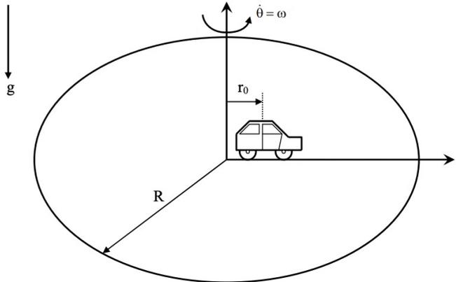
En lekebil står med hjulene i radiell retning på en lp-plate som vist på figuren. Platen roterer med med 33 runder pr. min., og den ligger horisontalt. Bilen har gummihjul, og vil ikke kunne skli sidelengs på platen. Ved tiden  $t=0$  står bilen stille i avstanden  $r_0 = 1$  cm fra senter på platen som har radius  $R = 15$  cm. Anta at bilen triller friksjonsløst i radiell retning.
